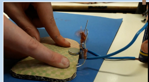
Il motorino elettrico
